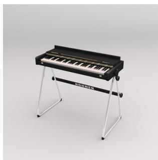
Dans le Pianet T, des lames sont relâchées par des ventouses en silicone et leurs vibrations sont converties en signal électrique par des micros électromagnétiques.
